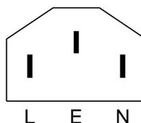
Рисунок 9 – Наименование цепей соединителя стыка электропитания при электропитании от сети переменного напряжения
