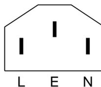
Рисунок 8 – Наименование цепей соединителя стыка электропитания при электропитании от первичного источника постоянного напряжения
